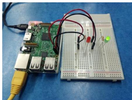
図2 GPIO を用いた LED 点灯制御
